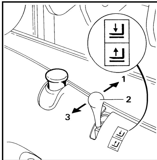
Por razones de seguridad, la velocidad de descenso mandada en el timón es inferior a la obtenida accionando la palanca del distribuidor.
