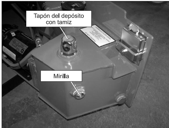
Figura 5 – Depósito de líquido hidráulico
