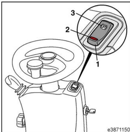
El símbolo del freno (consulte la flecha) en la unidad de visualización se ilumina permanentemente. La carretilla queda frenada.
