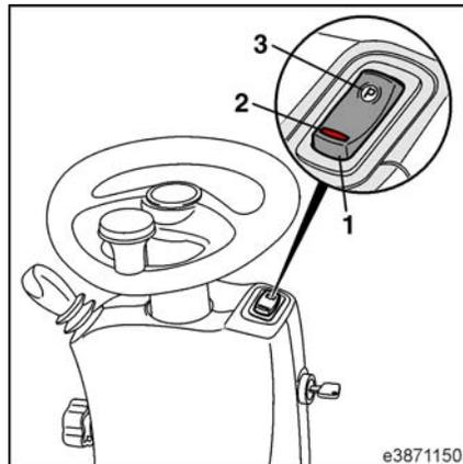
Accione el conmutador de freno (1) pulsando el símbolo (3) «P» (se ilumina el LED (2) rojo en el conmutador).
